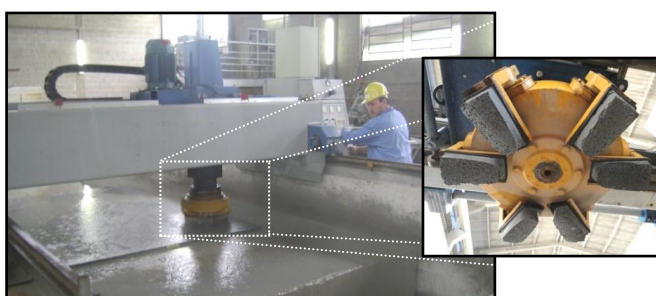
Figura 2: Ensaio de polimento. Em detalhe o satélite com os rebolos abrasivos acoplados.
