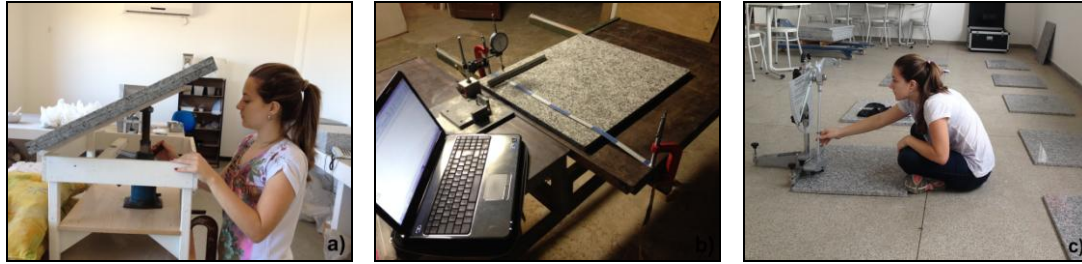
Figura 1: a) Ensaio de escorregamento com o Tilt Test . b) Medição da rugosidade. c) Ensaio de escorregamento com o Pêndulo Britânico.
