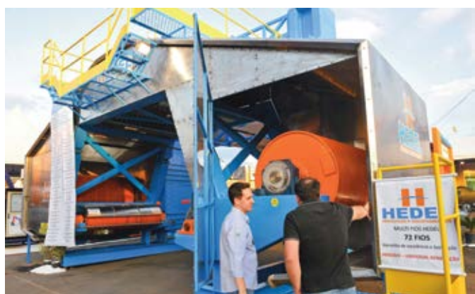
Tear 72 fios diamantados produzido pela Hedel Máquinas e Equipamentos em Agrolândia/SC. Foto: Célio Apolinário, 25/08/2015. A 72-wire gang saw produced by Hedel Máquinas, Agrolândia, SC. Photo: Célio Apolinário, 08/25/2015.
