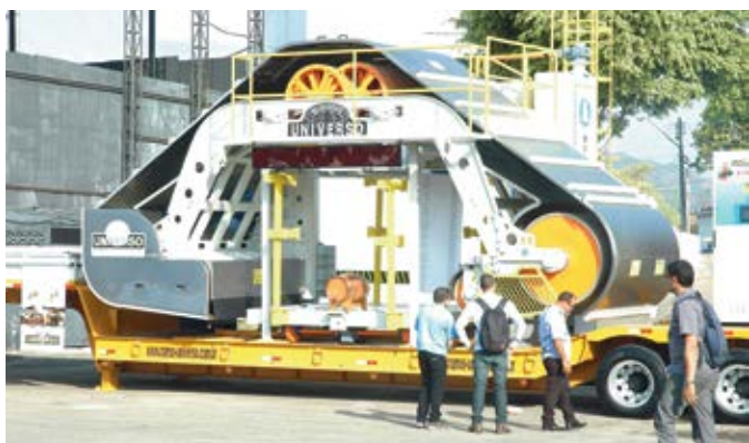
Tear multifoio diamantado da empresa Ramos Universo, localizada em Trombudo Central/SC. Foto: Célio Apolinário, 25/08/2015. Multi-wire gang saw by Ramos Universo, located in Trombudo Central, SC. Photo: Célio Apolinário, 08/25/2015.
