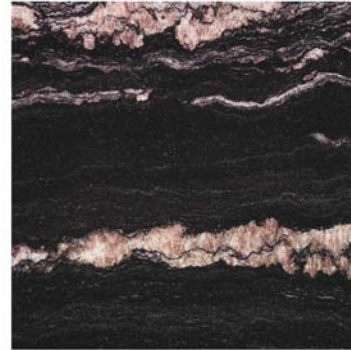
Foto 2 - Porto Rosa: granito (anfíbólio gnaíse) movimentado/anisótropo (Minas Gerais).
