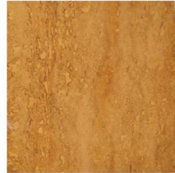
Foto 28 - Travertino Navona: estrutura bandada (Itália).
