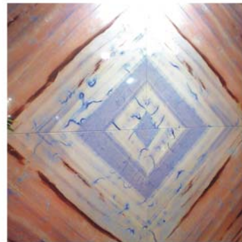
Foto 39 - Tycoon Blue: quartzito bandado maciço com dumortierita (Bahia).
