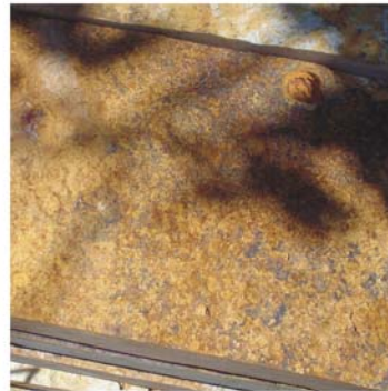
Foto 13 - Pedra Morisca: arenito conglomerático plaqueado (Piau).
