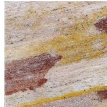
Foto 40 - Pedra Ouro Preto: quartzito mosqueado foliado (Minas Gerais).
