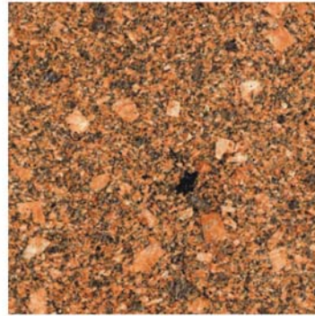
Foto 19 - Vermelho Bragança: granito inequigranular avermelhado (São Paulo).
