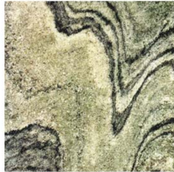
Foto 3 - Verde Van Gogh: granito (migmatito) movimentado, com padrão fantasia (Minas Gerais).
