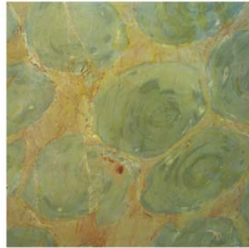
Foto 25 - Cappadocia: mármore fossilífero com estromatólitos (Paraná).
